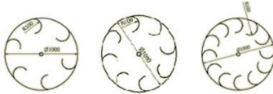
Gambar 2. Profile bilah cross flow pada tingkat kedua
